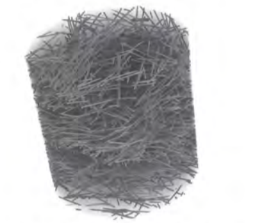
Computertomografie UHPC Bohrkern mit Stahlfasern. Quelle: FH-Weis, DI Schlotthauer
